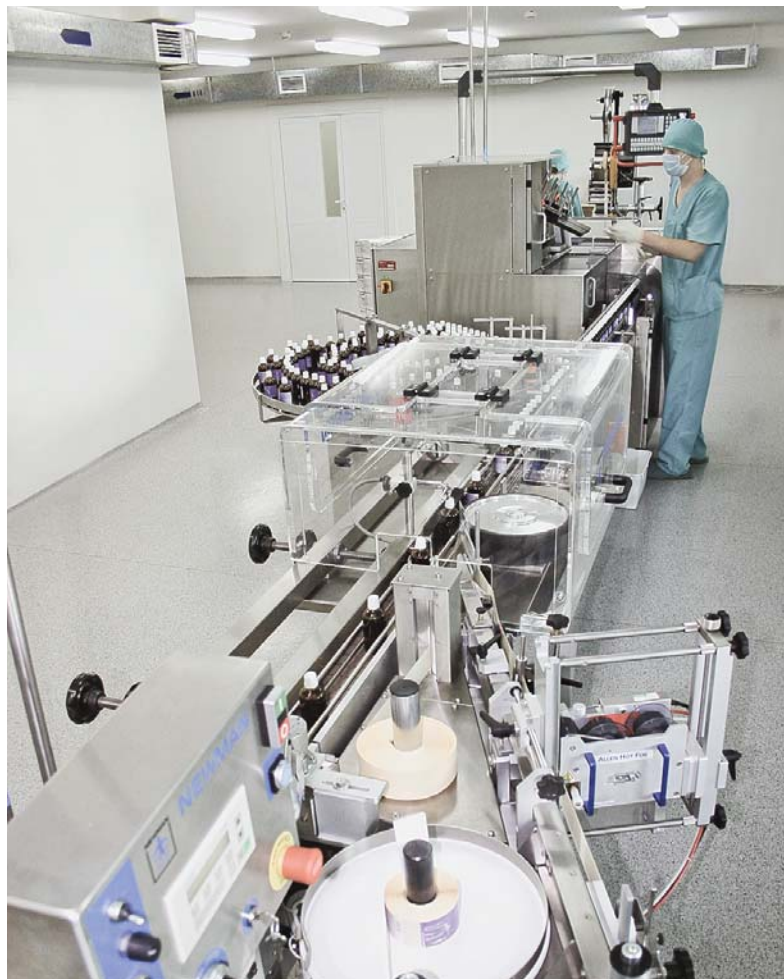
Немецкая автоматическая линия этикетирования и картонирования жидких форм
